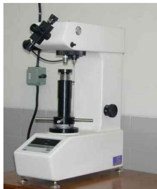
Gambar 3.14 Alat uji metode vikers dan skematis prinsip identitas
