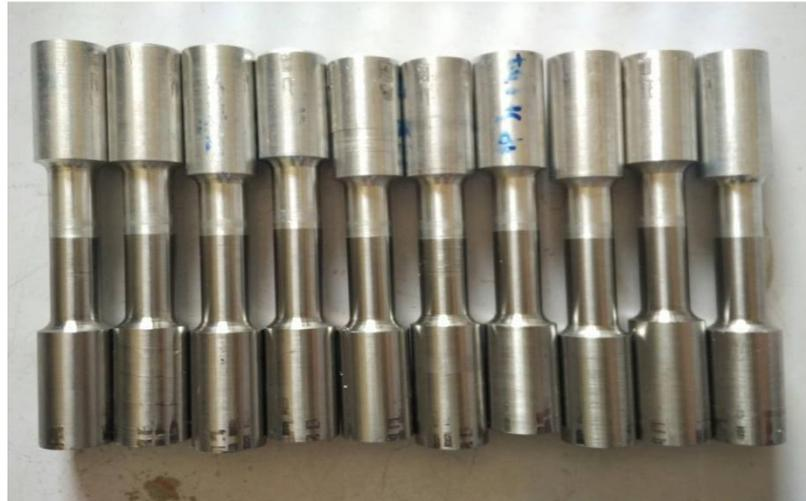
Gambar 4.8. Spesimen Uji Tarik Aluminium 6061 T6 dan stainless steel 304
