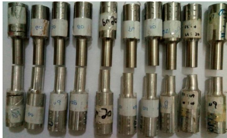
Gambar 4.11. Hasil pengujian tarik tekanan gesek 130 MPa, waktu gesek 4 detik, waktu tempa 5 detik dengan variasi tekanan tempa (a) 50 MPa, (b) 60 MPa, (c) 70 MPa, (d) 80 MPa, (e) 90 MPa, (f) 100 MPa, (g) 110 MPa, (h) 120 MPa, (i) 130 MPa, (j) 140 MPa Aluminium 6061 T6 dan Stainless Steel 304
