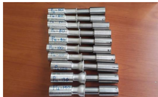
Gambar 4. Hasil pengelasan CDFW pada bahan AL 6061 T6 dan SS 304.
