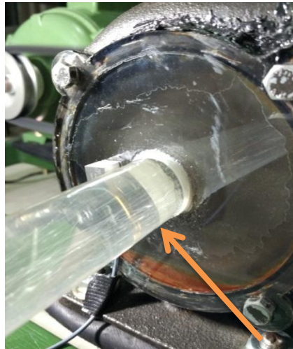
Gambar 3.18 Kondisi variasi tutupan 4 (tertutup 80%) dengan kavitasi level 4
