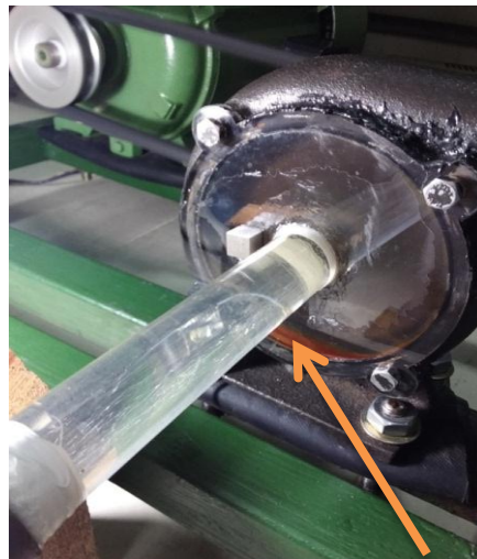
Gambar 3.17 Kondisi variasi tutupan 3 (tertutup 60%) dengan kavitasasi level 3
