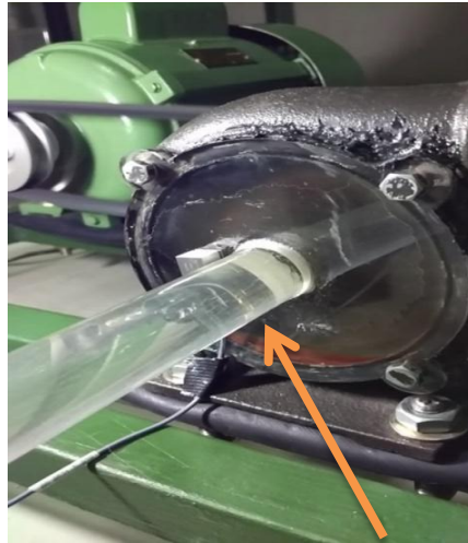
Gambar 3.16 Kondisi variasi tutupan 2 (tertutup 40%) dengan Kavitasasi level 2
