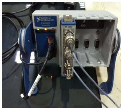
Gambar 3.8 Modul data akuisisi terpasang pada chassis
