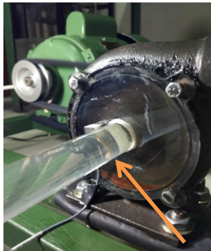
Gambar 3.15 Kondisi variasiutupan 1 (tertutup 20%) dengan kavitasi level 1
