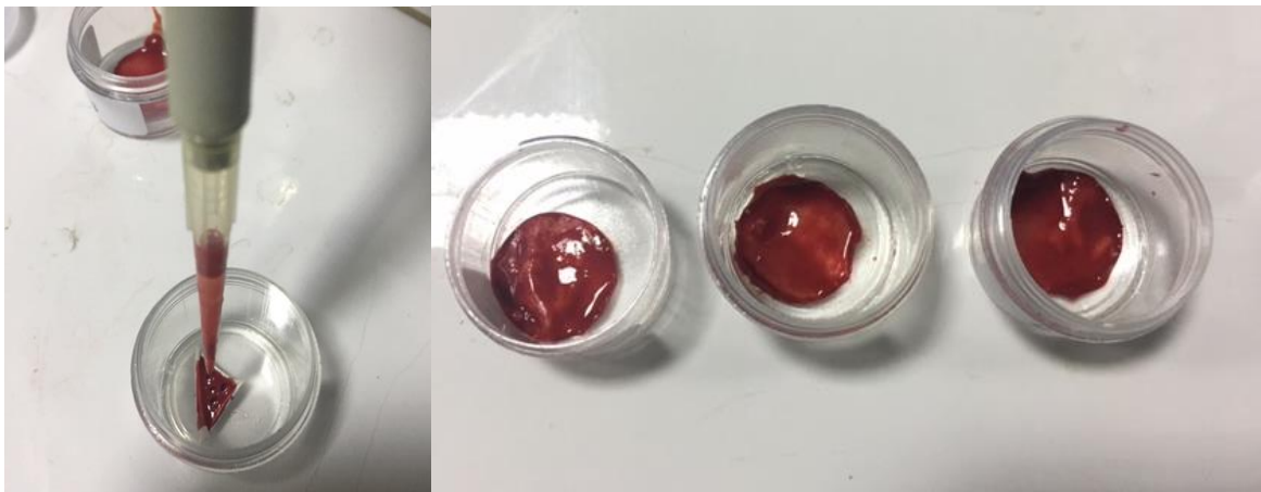
Gambar 14. Proses inkorporasi perancah dengan teknik tetes selama 15 menit
