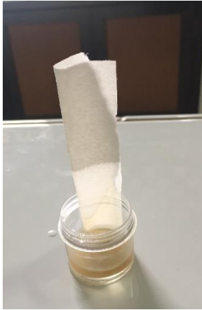
Gambar 20. Proses memisahkan larutan aquadest setelah inkubasi
