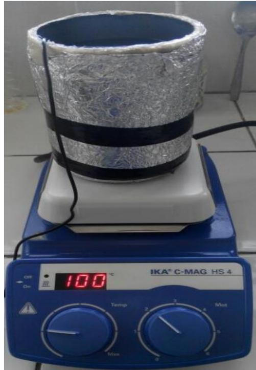
**Gambar 3.18** Posisi meletakkan sampel oli
