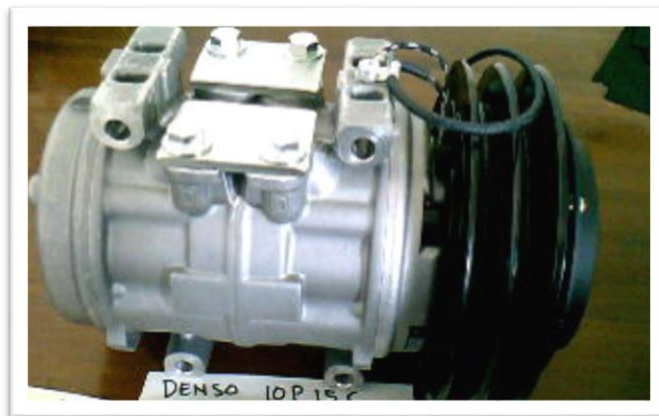
Gambar 3.3 Kompresor NIPPONDENSO 10P15C
