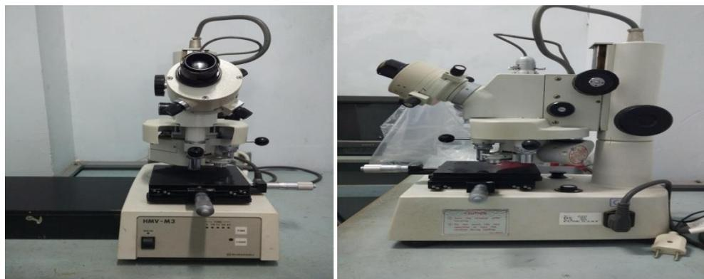
Gambar 3.9 Alat uji kekerasan mikro vikers
