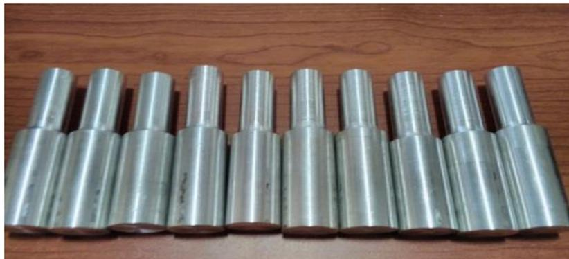
Gambar 3.12 potongan dan pembubutan alumunium dibuat dengan standar JIS 2201
