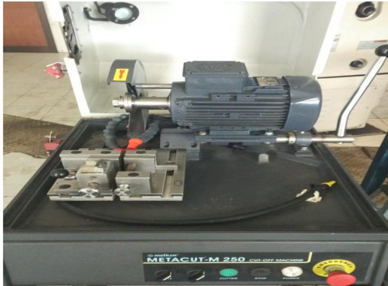
Gambar 3.8 mesin gerjasi motor
