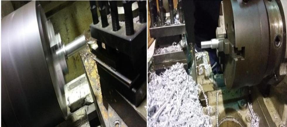
Gambar 3.13 Meratakan ujung benda kerja alumunium 6061 T6
