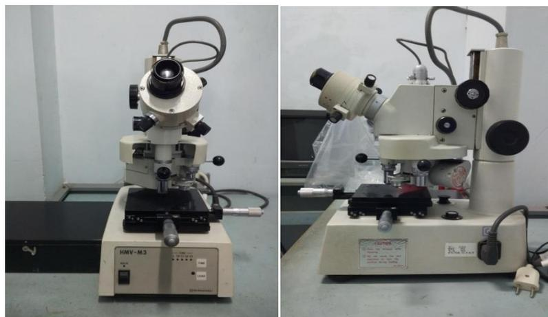
Gambar 3.17 Alat uji kekerasan *vickers*
