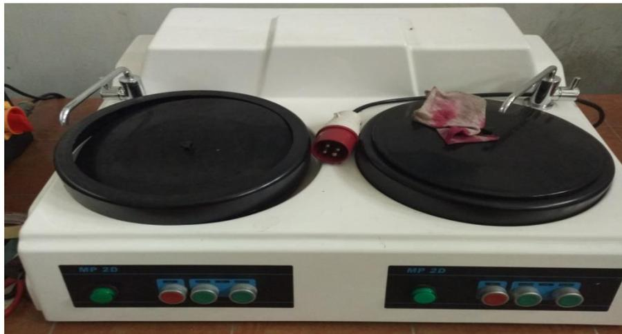
Gambar 3.10 Alat mesin poles
