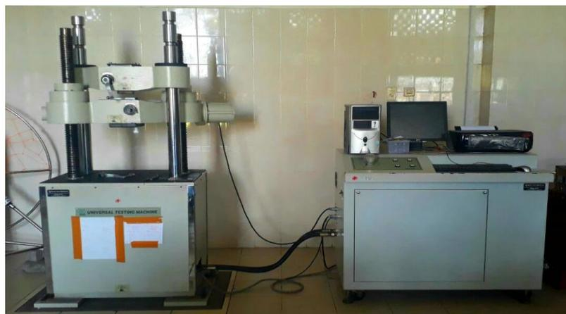
Gambar 3.4 Mesin Uji Tarik
