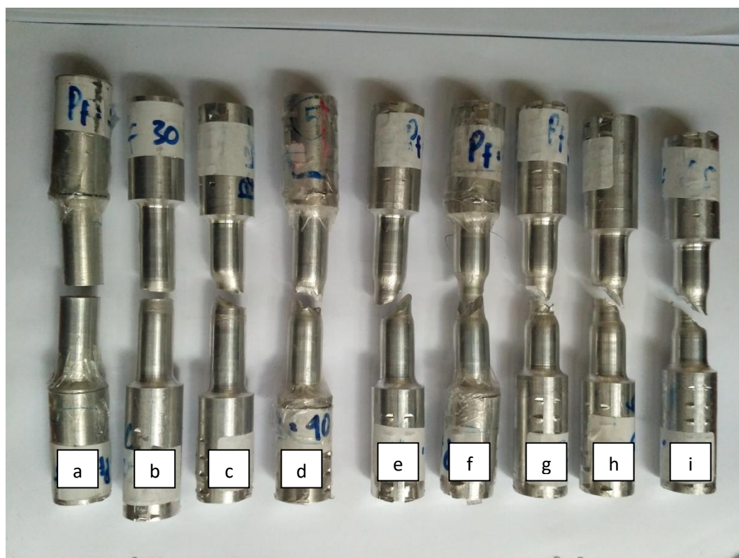
Gambar 4.10 Hasil patahan uji tarik (a) variasi 25 MPa, (b) variasi 30 Mpa, (c) variasi 35 MPa, (d) variasi 40 MPa, (e) variasi 45 MPa, (f) variasi 50 MPa, (g) variasi 55 MPa, (h) variasi 60 MPa, (i) variasi 65 MPa
