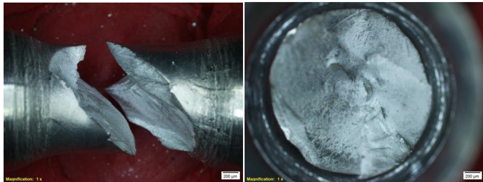
Gambar 4.11 Hasil patahan uji tarik variasi tekanan gesek 50 MPa
