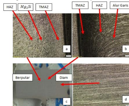
Gambar 6 Hasil struktur mikro variasi tekanan gesek 25 MPa (a) aluminium yang berputar, (b) aluminium yang diam, (c) foto makro, (d) daerah logam induk.
