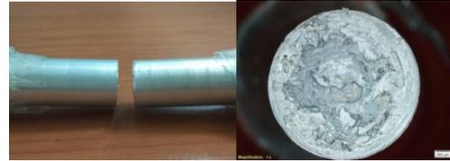
Gambar 12 Hasil patahan uji tarik variasi tekanan gesek 25 MPa.
