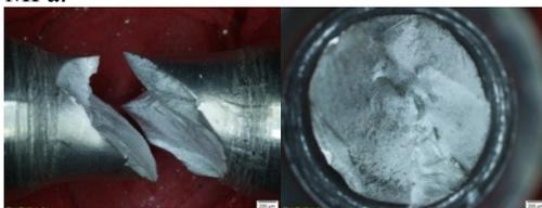
Gambar 11 Hasil patahan uji tarik variasi tekanan gesek 50 MPa
