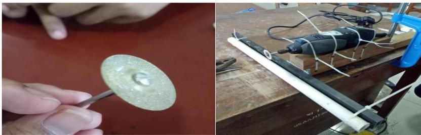
Gambar 12 Alat *separating disk* yang digunakan untuk memotong gigi
