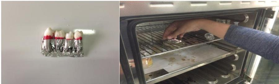
Gambar 10 Gigi dibungkus *aluminium foil* lalu dimasukkan dalam inkubator
