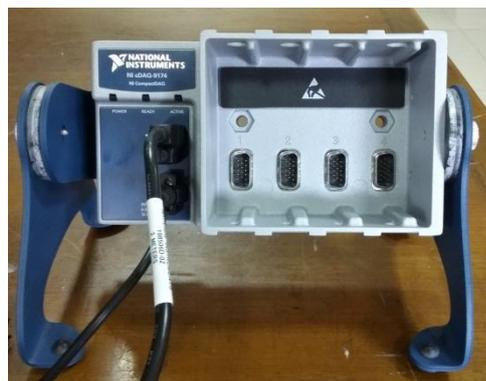
Gambar 3.8. *Chassis* Modul Data Akuisisi
