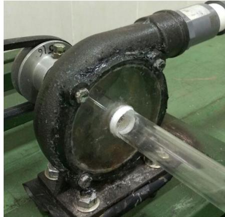
Gambar 3.3. Pompa Sentrifugal.
