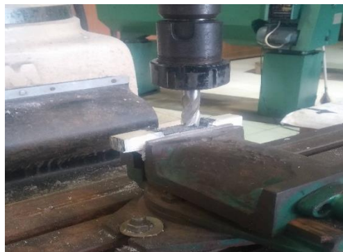
Gambar 3.25 . Proses pembentukan specimen uji tarik sesuai ASTM D638
