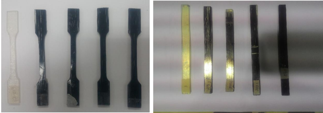
Gambar 3.26. (A) Spesimen tarik (ASTM D638) dan (B) tekan (ASTM D3410) siap uji
