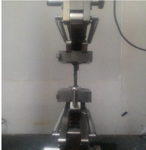
Gambar 3.27. Posisi pemasangan spesimen
