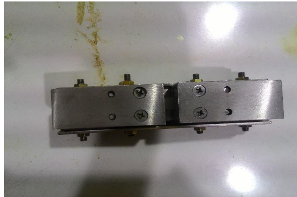
Gambar 3.29. pemasang Alignment jig pada specimen uji
