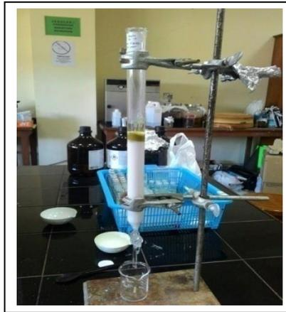
**Gambar 16.** Proses elusi kromatografi kolom
