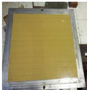
Gambar 3.23. Pemasangan Lakban Pada Cetakan.
