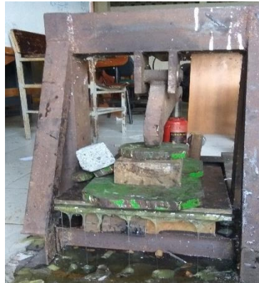
Gambar 3.26. Pengepresan Alat Press Mold Menggunakan Dongkrak Botol Hidrolik.
