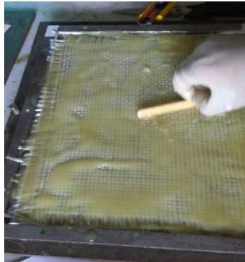
Gambar 3.25. Perataan Matrik Pada Permukaan Serat Gelas.
