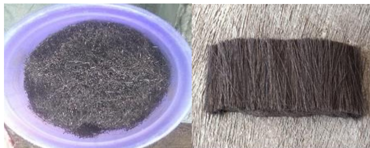
Gambar 3.18. Proses Perlakuan Serat Ijuk dan Pematangan Ijuk.
