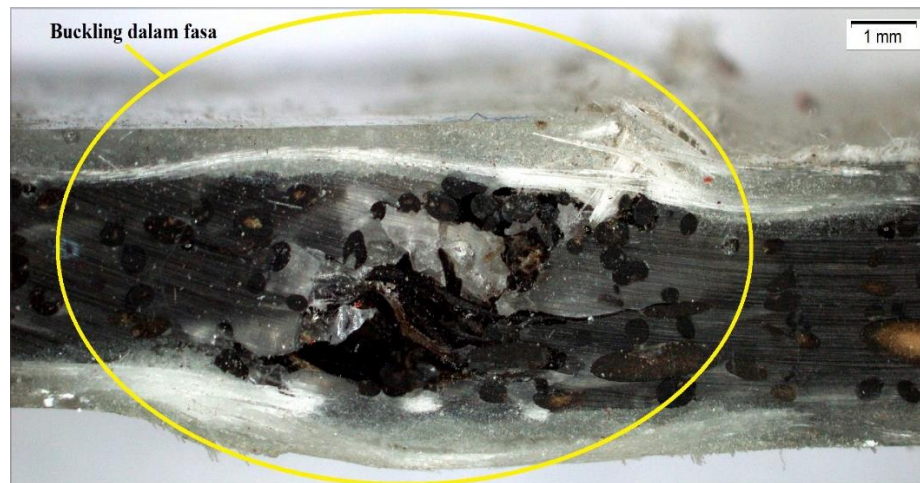
Gambar 4.7. Foto Patahan Spesimen Tekan (a) 0 Lapis Serat Gelas; (b) 2 Lapis Serat Gelas (c) 4 Lapis Serat Gelas.
