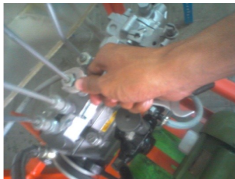
Gambar.4.27. Sambungan Pipa Tekanan Tinggi pada katup penyalur
