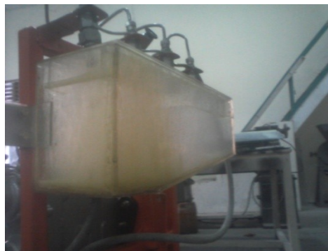
Gambar. 4.35. nosel 1,2,3,dan 4 menyemprotkan solar
