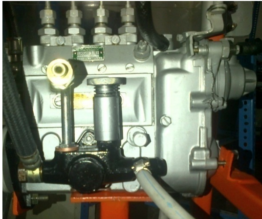
Gambar.4.12. Pompa Injeksi yang dipasang pada braket.
