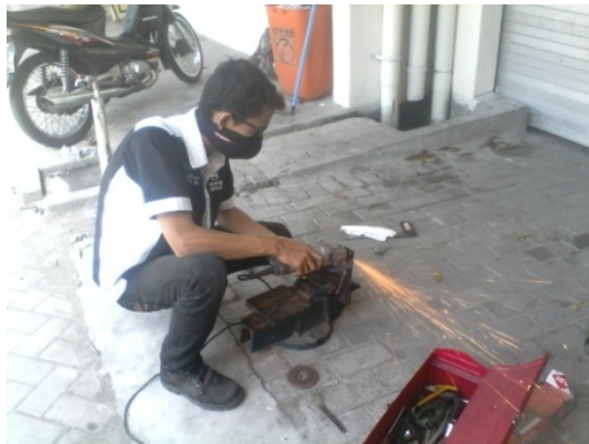
Gambar.4.2. Memotong Material Braket Pompa Injeksi
