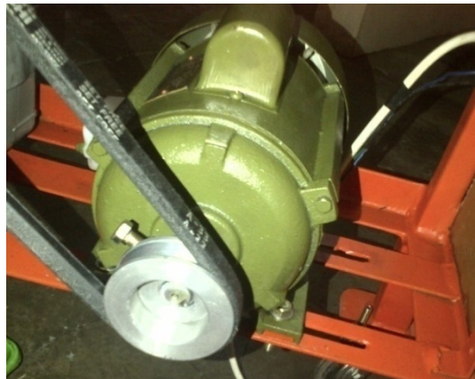
Gambar. 4.13. Motor Listrik pada dudukannya
