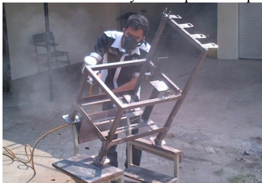
Gambar. 4.6. Proses Epoxy Primer
