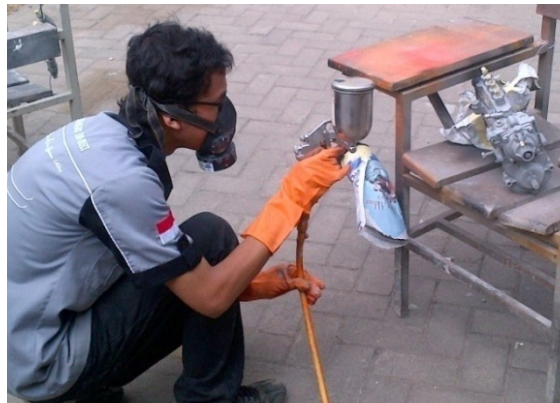
Gambar. 4.11. Pengaplikasian Cat Warna pada Pompa Injeksi
