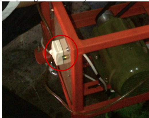
Gambar.4.29. Saklar dan lampu Indikator Menyala
