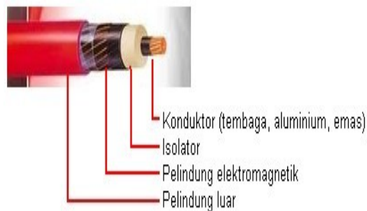
Gambar 2.18. Bagian-bagian kabel (Sumber :Anonim 2000)
