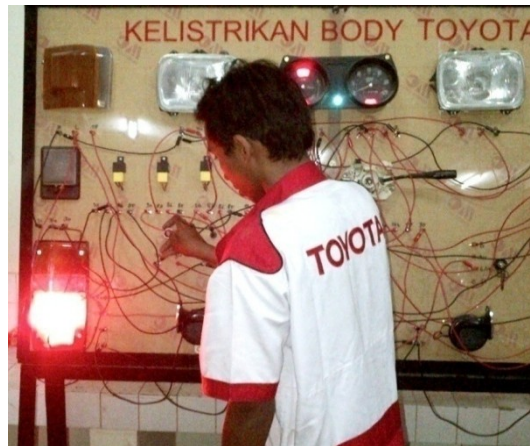
Gambar 4.15. Lampu rem dan indikator menyala ketika ditekan
