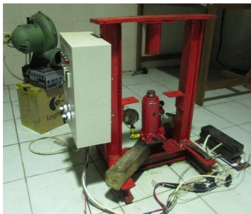
Gambar 3.9 Mesin hot press hasil rekayasa
