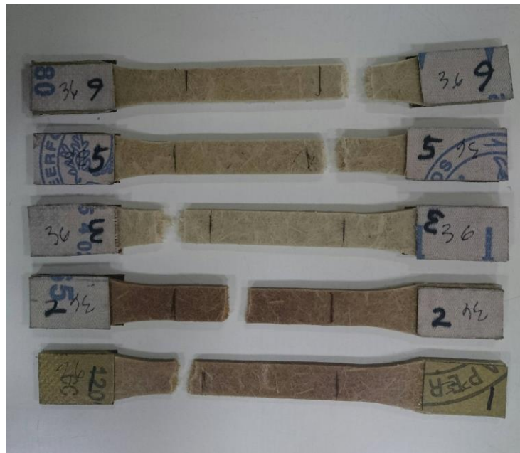
Gambar 4.3 Patahan hasil uji tarik variasi 36 jam alkalisasi serat
