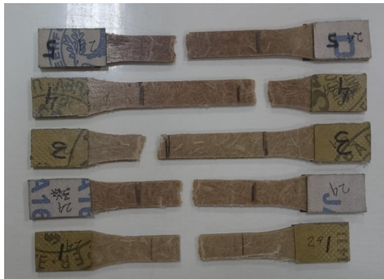
Gambar 4.2 Patahan hasil uji tarik variasi 24 jam alkalisasi serat
