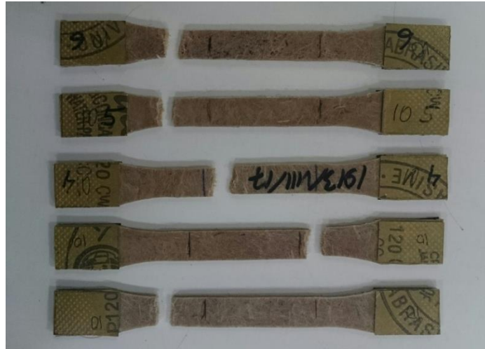
Gambar 4.1 Patahan hasil uji tarik variasi 10 jam alkalisasi serat
