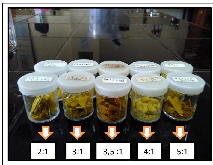
Gambar 11. Hasil pemurnian GVT-0 dengan variasi perbandingan starting material vanilin dan aseton (2:1, 3:1, 4:1, dan 5:1).
