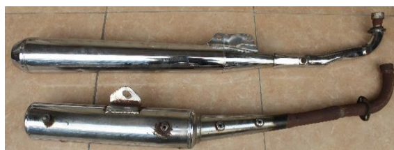
Gambar 3.8. Knalpot standar (atas) & knalpot modifikasi (bawah)
