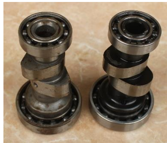
Gambar 3.6. Camshaft standar (kiri) & camshaft racing K1 (kanan)
