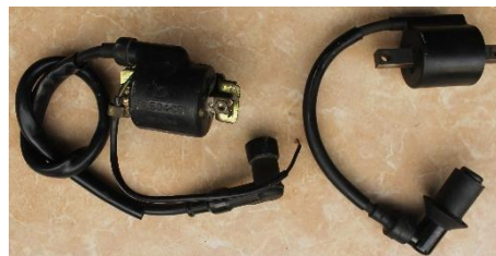
Gambar 3.7. Koil standar (kiri) & koil YZ 125 (kanan)
