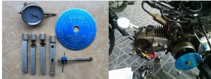
Gambar 3.5. Dial indicator (kiri) & pemasangan dial di motor (kanan)
