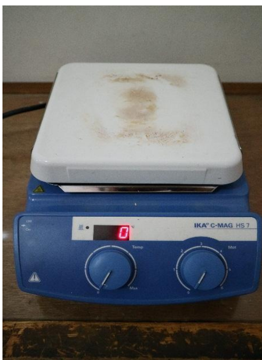
Gambar 3.4 Hot plate (kompor listrik)
