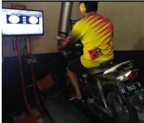
**Gambar 3.12** Proses pengujian menggunakan *dynamometer*
