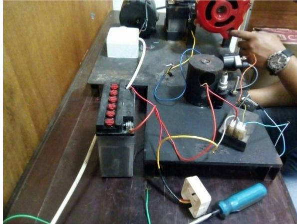
**Gambar 3.20** Proses pengujian percikan bunga api
