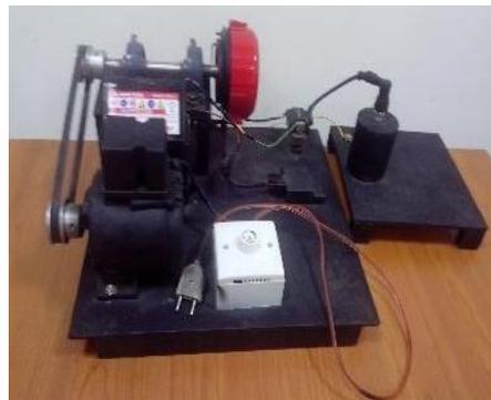
**Gambar 3.7.** Alat pengujian percikan bunga api pada busi
