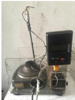
**Gambar 3. 13** Alat uji titik nyala (*flash point*)
