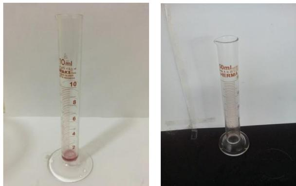
**Gambar 3. 9** Gelas ukur 10 ml (kiri), gelas ukur 50 ml (kanan)
