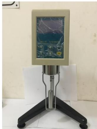
**Gambar 3. 12** Alat uji viskositas NDJ 8S
