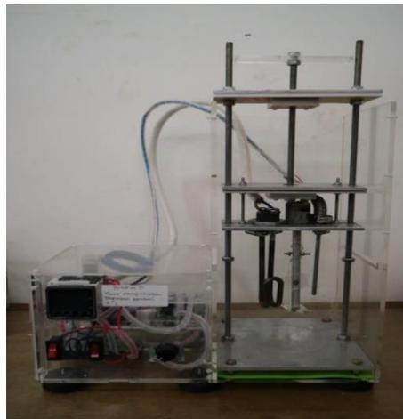
**Gambar 3. 11** Alat pembuat biodiesel
