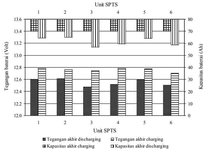
Gambar 7. Kondisi Tegangan dan Kapasitas Baterai
