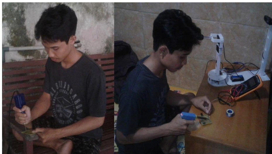
Gambar 3. 12 Proses pengeboran PCB dan penyolderan kaki komponen
