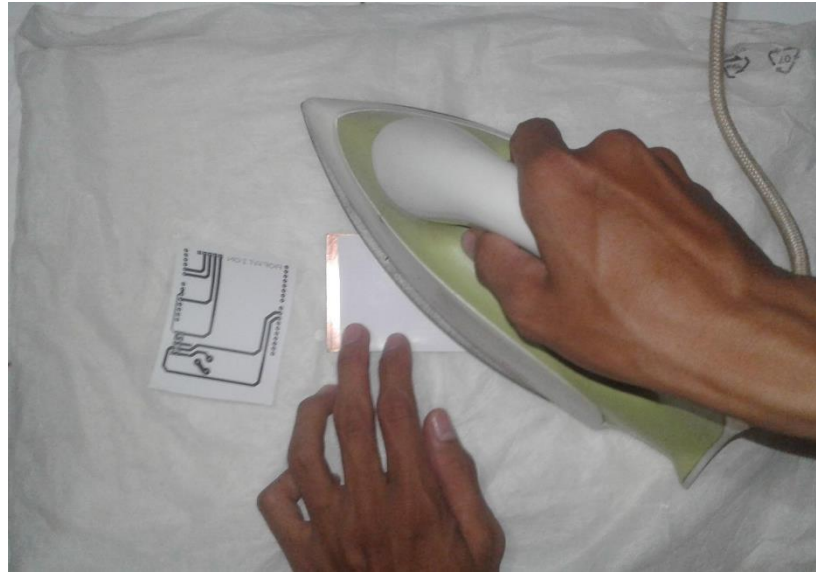
Gambar 3. 10 Proses penempelan rangkaian ke papan PCB
