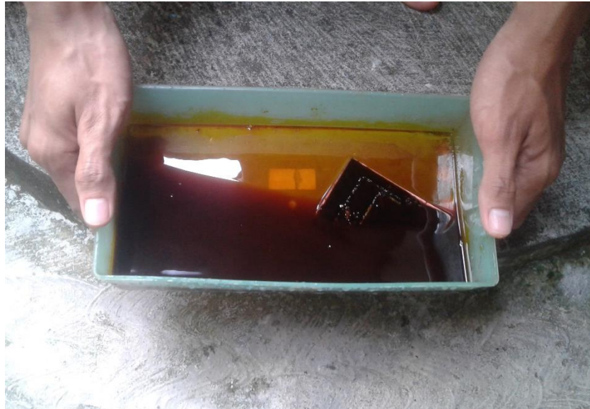
Gambar 3. 11 Proses melarutkan PCB
