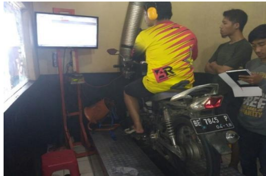
Gambar 3.19 Alat uji Torsi dan Daya dengan dynamometer
