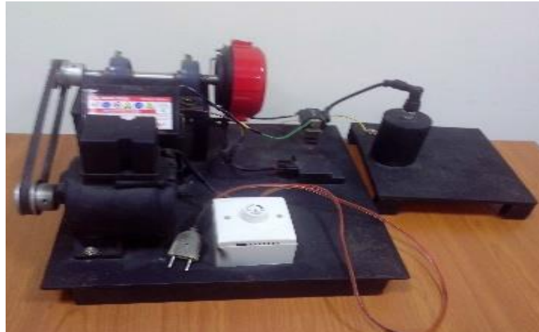
Gambar 3.9 Alat penguji percikan bunga api pada busi
