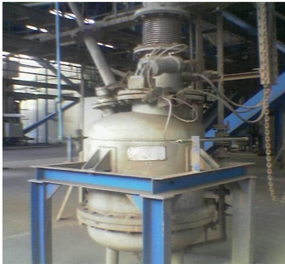
Gambar 2.12 Tabung Transporter ukuran 0,85 m<sup>3</sup> dan 0,25 m<sup>3</sup>
