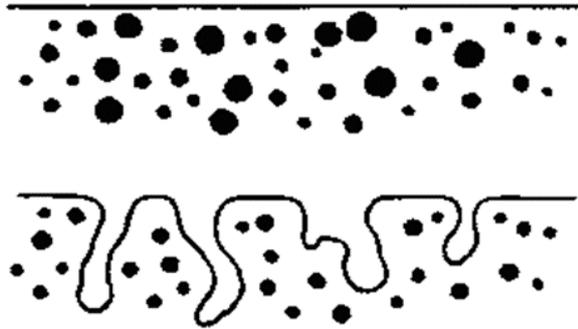
Gambar 2.2 Permukaan plastik ABS sebelum dan sesudah proses *Chemical Etching* (Wahyudi, 2012)
