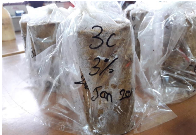
Gambar 3. 7 Benda uji yang siap diperamkan sesuai dengan variasi umur pengujian
