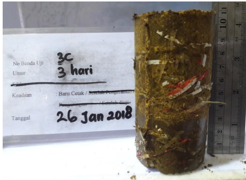
Gambar 3. 6 Benda uji setelah dikeluarkan dari cetakan
