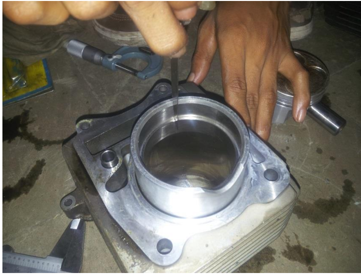
Gambar 3.14 Pengukuran Celah Ring Piston Didalam Cylinder
