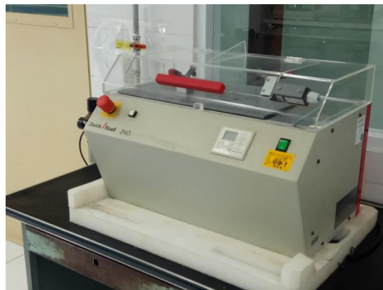
Gambar 2. 10 Gambar alat pembuat v-notch
