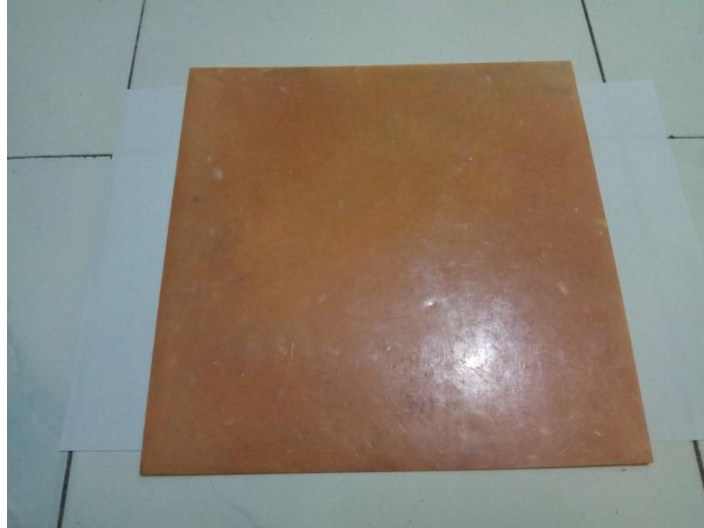
Gambar 2. 4 Hasil Hot Press Molding berbentuk Plat PVC
