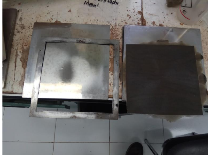
Gambar 3. 14 Hasil proses pembuatan Plat PVC/Initial color/ Fly ash
