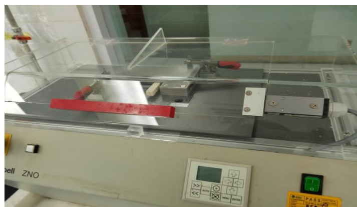
Gambar 3. 31 kondisi mesin siap di kerjaan pembuatan celah v-notch
