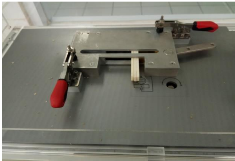
Gambar 3. 30 Posisi tempat pengunci pada mesin pembuat celah v-notch
