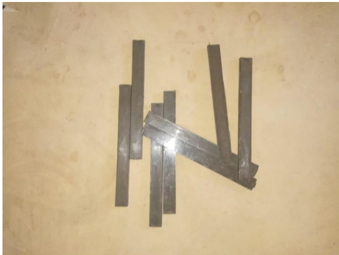
Gambar 3. 18 Spesimen impact sesudah di bersihkan
