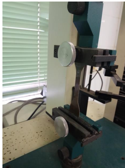
Gambar 3. 24 Posisi specimen sudah di jepit pada kedua sisi
