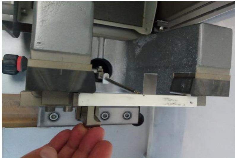
Gambar 3. 35 Posisi celah v-notch tepat pada garis tengah
