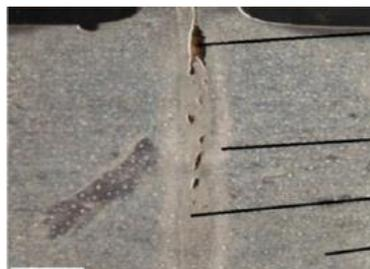
**Gambar 2.3.** Struktur makro daerah las pada pengelasan gesek
