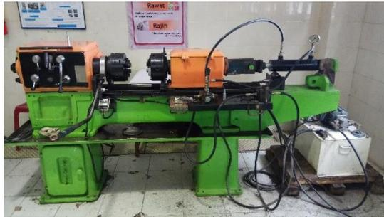
**Gambar 3.2.** Mesin las gesek (*friction welding*)
