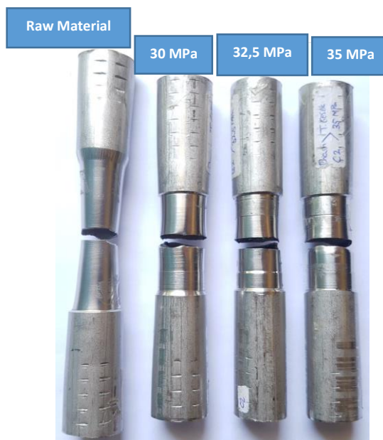
Gambar 4.9. Hasil patahan spesimen uji tarik
