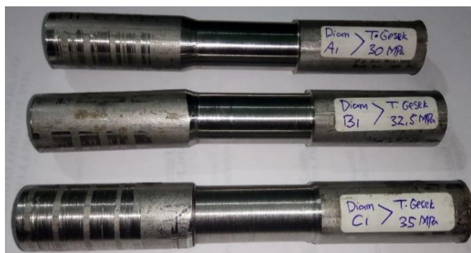
Gambar 4.3. Hasil pesimen pengujian tarik
