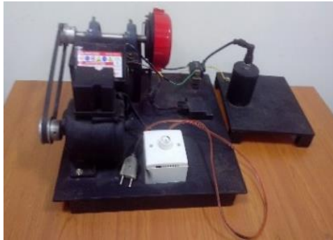
Gambar 3.13 Alat Uji Pengapian Busi
