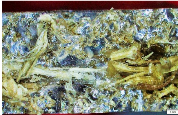
Gambar 4.12. Penampang hasil uji Tarik variasi 2 (a). Penampang patahan sudut diagonal. (b). Penampang patahan tampak atas
