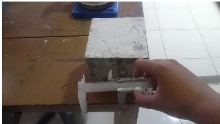
Gambar 3.27. Pengukuran area luasan benda uji
