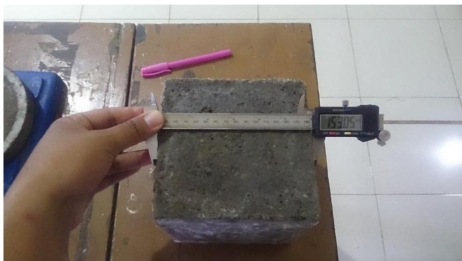
Gambar 3.16. Proses pengukuran dimensi
