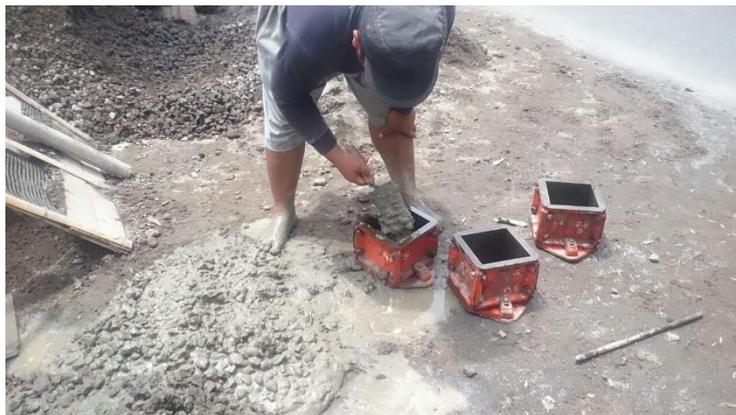
Gambar 3.9 Proses pengecoran kedalam cetakan
