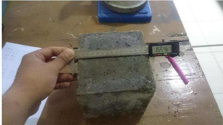
Gambar 3.26. Pengukuran dimensi benda uji
