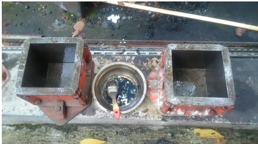
Gambar 3.5. Persiapan cetakan benda uji
