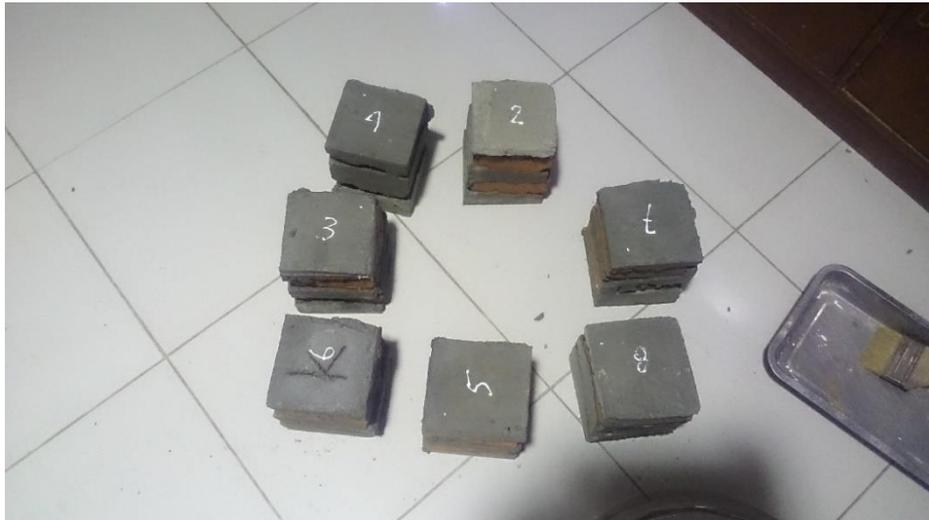
Gambar 3.24. Lepas cetakan yang berbentuk kubus kayu
