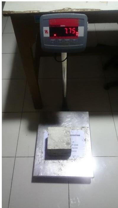
Gambar 3.25. Timbang 10 benda uji
