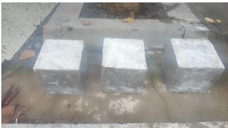
Gambar 3.14. Benda uji beton diangkat pada bak rendaman
