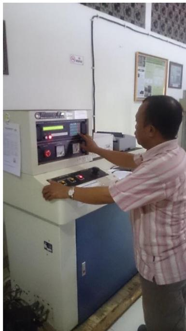
Gambar 3.28. Input data dimensi dan luasan ke *Concrete Testing Machine*
