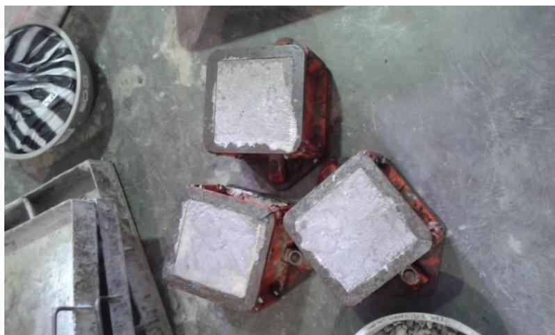
Gambar 3.11. Diamkan benda uji selama 24 jam sebelum lepas cetakan
