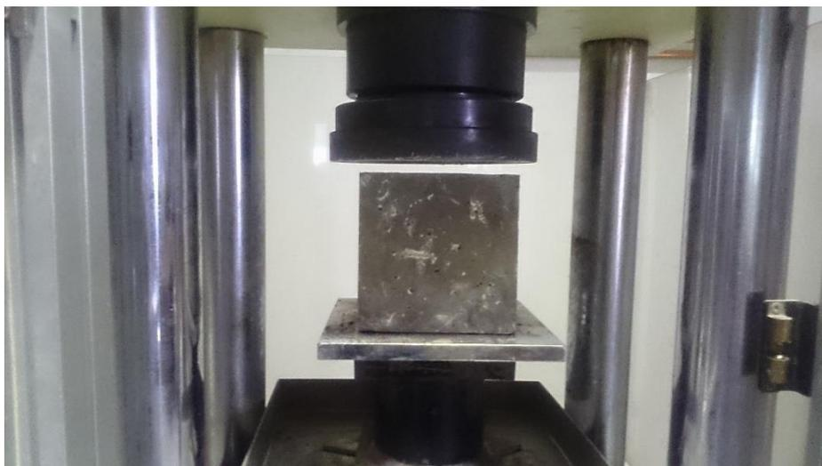
Gambar 3.18. Proses uji tekan beton
