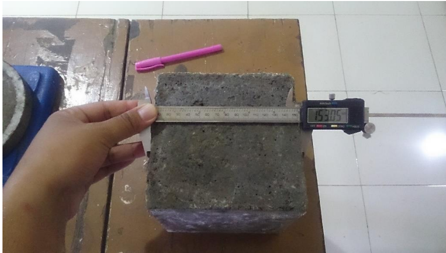
Gambar 4.3. Proses pengukuran dimensi Benda uji beton
