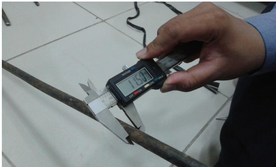
Gambar 4.4. Benda uji baja tulangan beton
