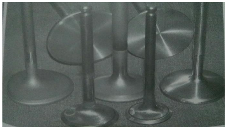
Gambar 2.4 Contoh valve pada motor bakar (Bettes, 2010)
