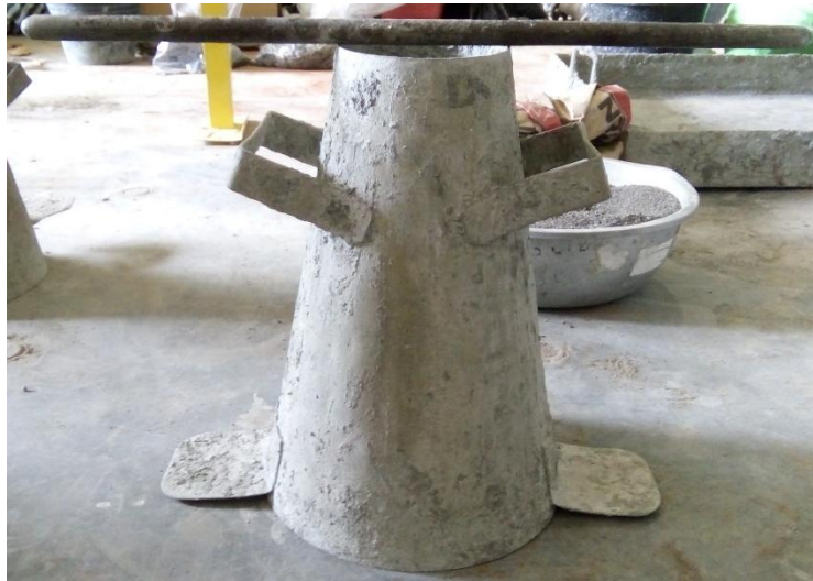
Gambar 3.7 Kerucut Abhrams untuk uji slump
