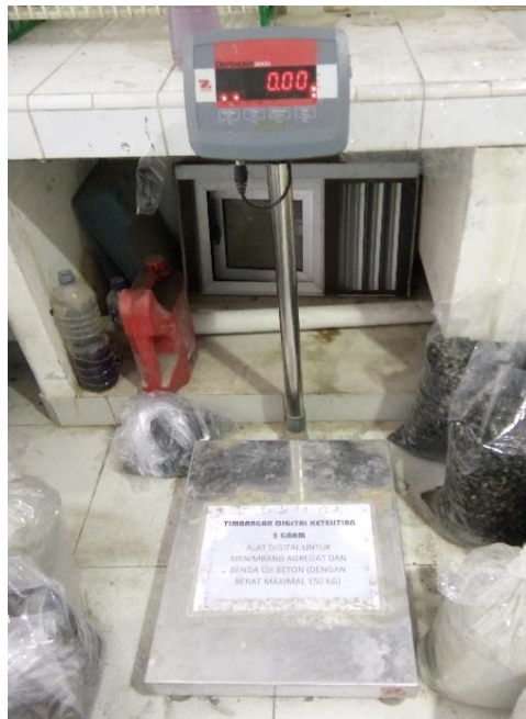
Gambar 3.3 Timbangan digital dengan ketelitian 5 gram
