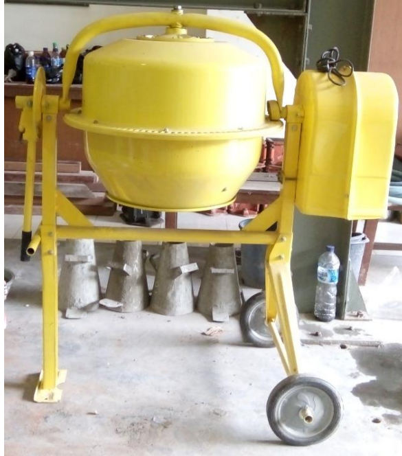
Gambar 3.6 Mixer dengan kapasitas 40kg
