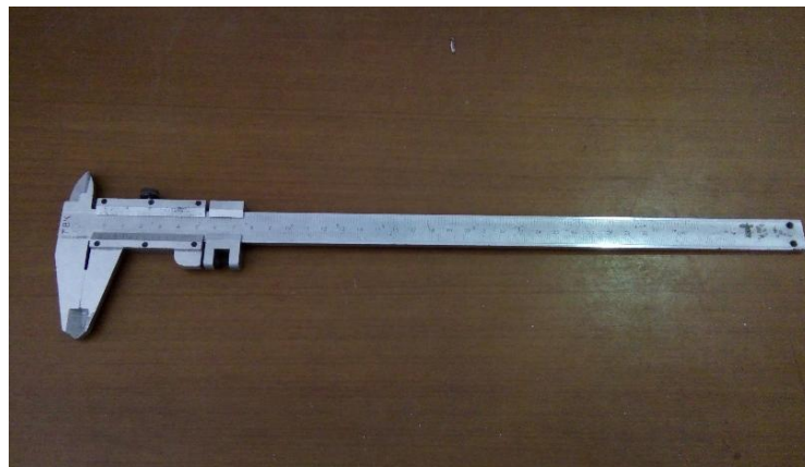
Gambar 3.9 Kaliper dengan ketelitian 0,05mm
