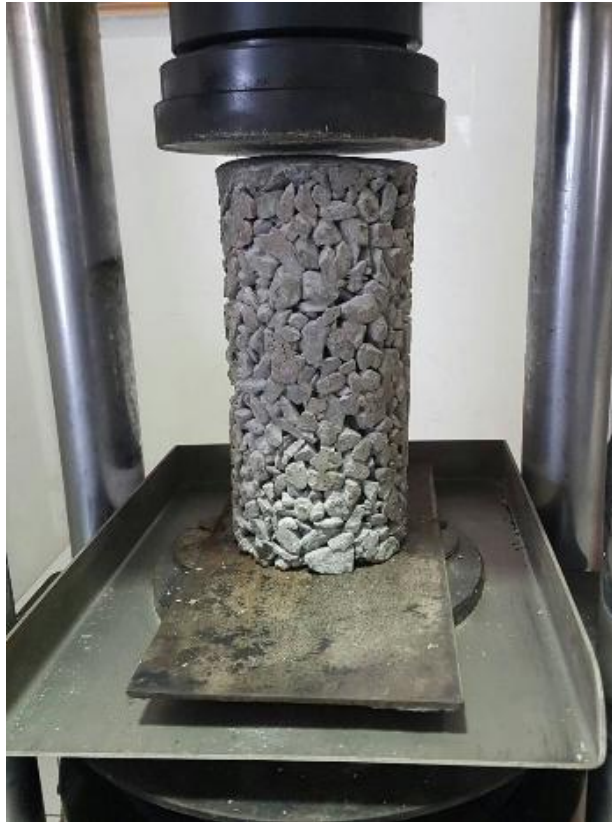
Gambar 4.9 Benda uji sebelum diuji tekan
