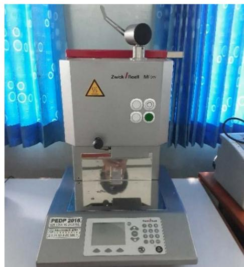
Gambar 3.6 Alat Uji MFI Model Otomatis
