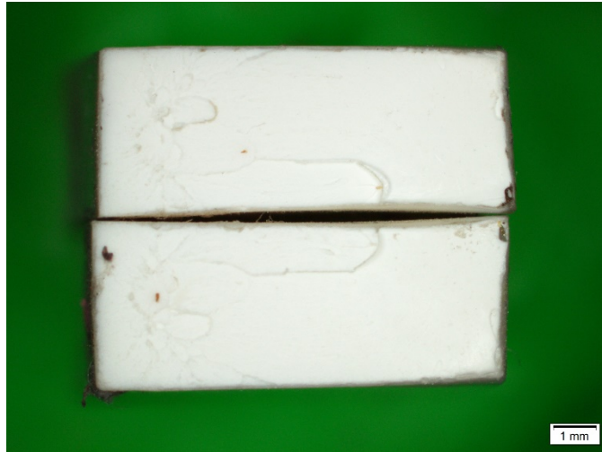
Gambar 4.10 Patahan Uji Tarik Spesimen ABS Daur Ulang 1 Kali
