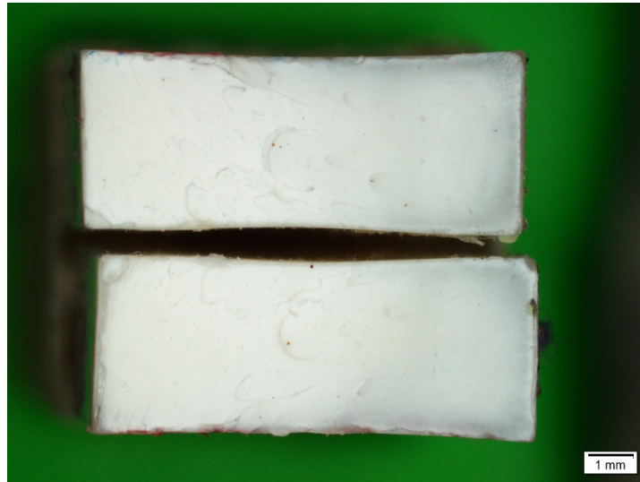
Gambar 4.15 Patahan Uji Impak Spesimen ABS Daur Ulang 3 Kali
