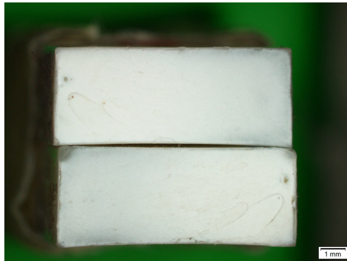
Gambar 4.14 Patahan Uji Impact Spesimen ABS Daur Ulang 1 Kali
