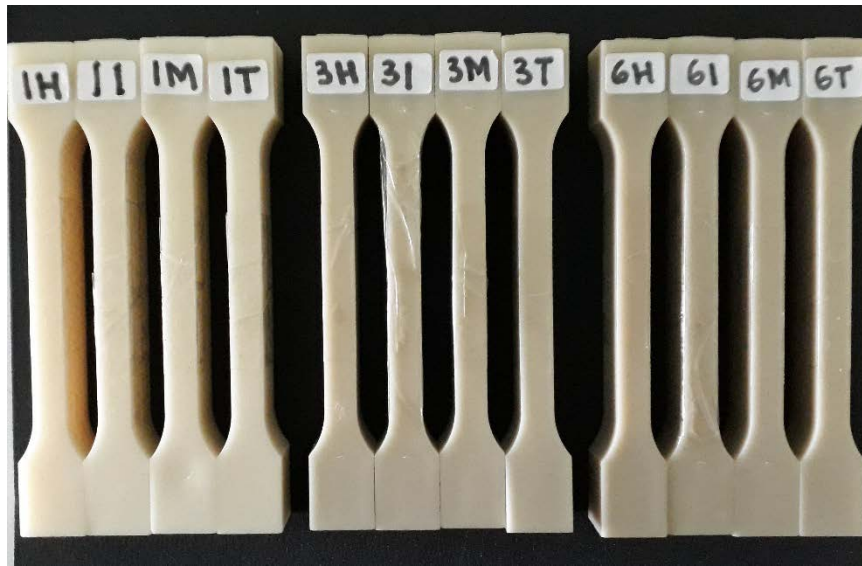
Gambar 4.2 Spesimen Multipurpose ABS Daur Ulang 1, 3, dan 6 Kali
