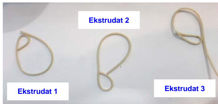
Gambar 3.11 Ekstrudat Hasil Uji MFI
