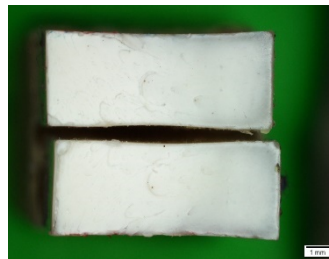
Gambar 3.7 Patahan ABS Daur Ulang 3 Kali
