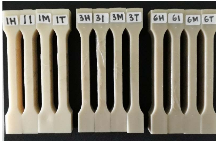
Gambar 3.1 Spesimen multipurpose ABS daur ulang 1, 3, dan 6 kali
