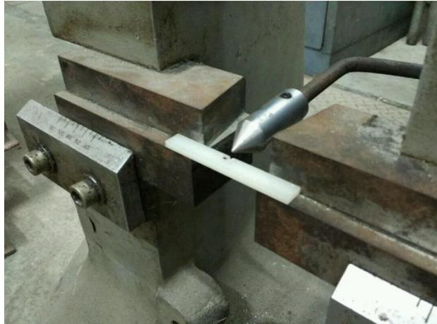
**Gambar 3.10** posisi spesimen Uji Impak
