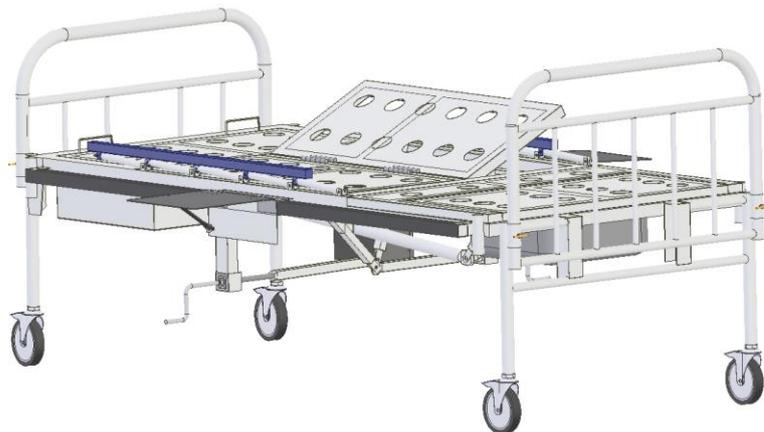
Gambar 4.14 Engkol (*Crank*) penambahan fitur pada bagian tengah Perancangan *Bed*
