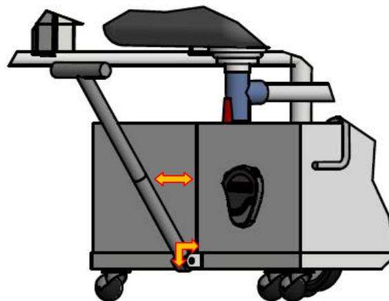
Gambar 4.65 Mekanisme Tuas dari Penempatan *Reservoir Tank*
